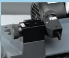
2. Mikrométer pontossággal állítható letapogató
